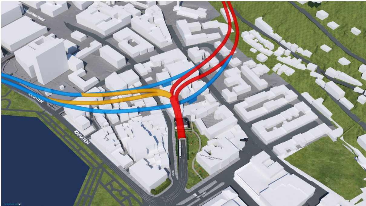
Il. 5. Påkobling av TBM tunnel. 3D illustrasjon.
