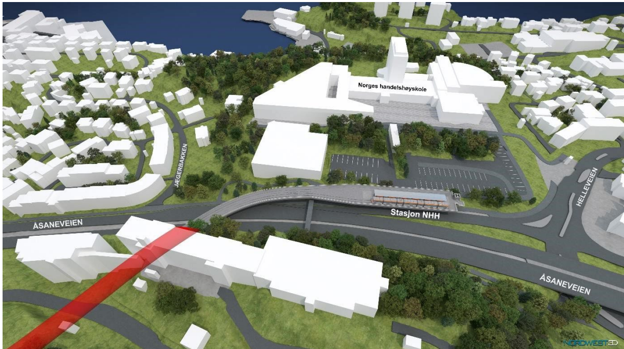
Ill. 9. Holdeplass NHH. Tunnelutløp (vist i rødt) i fjellskrent under Hatleberg studentbolig.
