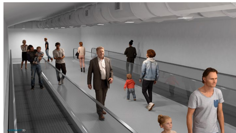
Gangtunnel med rullefortau i begge retninger.
